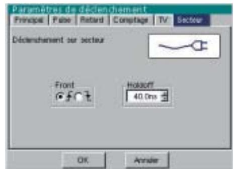
Outre ces multiples modes de paramétrages, le **Holdoff** est disponible sur la majorité de ces modes de déclenchement. Cette fonction permet de stabiliser le signal en inhibant le déclenchement pendant une durée définie par l'utilisateur.
